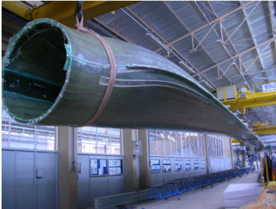
Fabricación de las palas del aerogenerador E-70 2 MW de **ENERCON**
