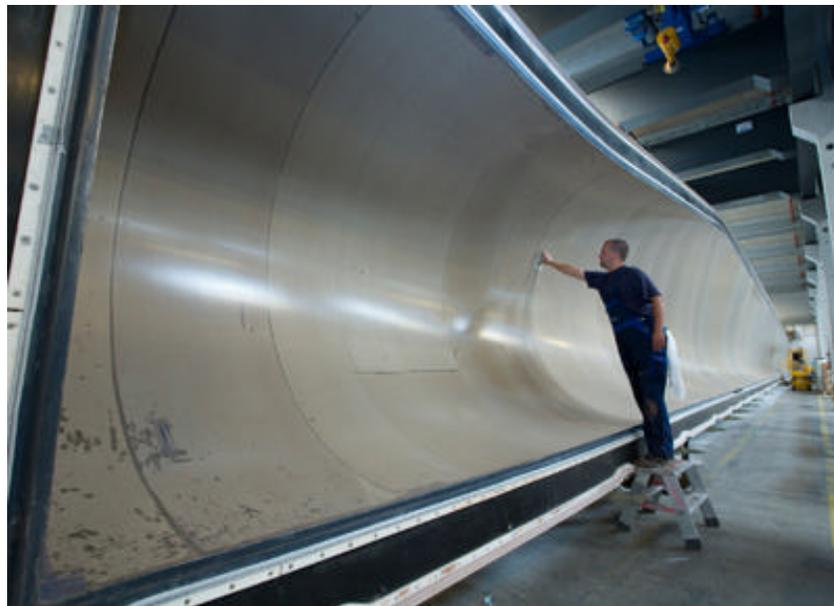
Procedimiento de fabricación integral de palas **IntegralBlade®** patentado por **SIEMENS**
